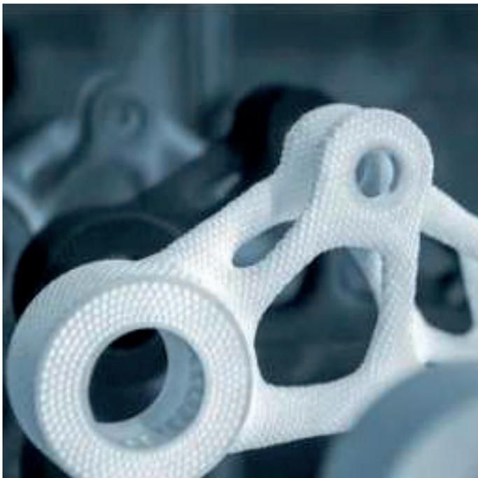
Selektives Lasersintern (SLS) ist eine additive Fertigungstechnologie, bei der ein Laser auf eine Schicht von pulverförmigem Material gerichtet wird, um es selektiv zu schmelzen und zu verfestigen.
